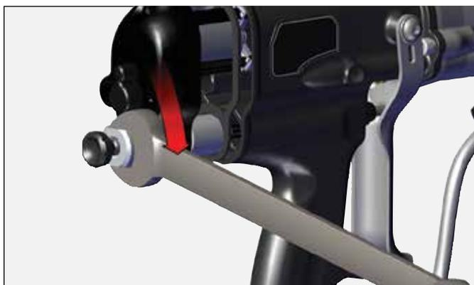
9. Install fan air valve cartridge.
