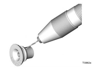
Fig. 2. Cleaning Component B (Resin) Ports
