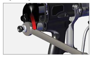
9. Install fan air valve cartridge.
