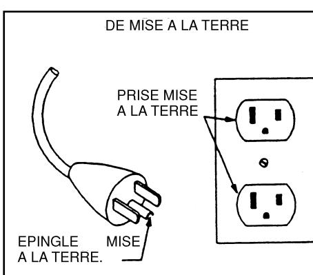
priée de mise à la terre. La fiche doit être branchée sur une prise qui est posée et mise à la terre adéquatement conformément à tous les codes et
