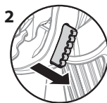
Gatilho desbloqueado (a pistola pulveriza)
