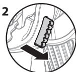
Gatillo desbloqueado (la pistola sí pulveriza)
