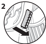
Détente débloquée (le pistolet pulvérise)
