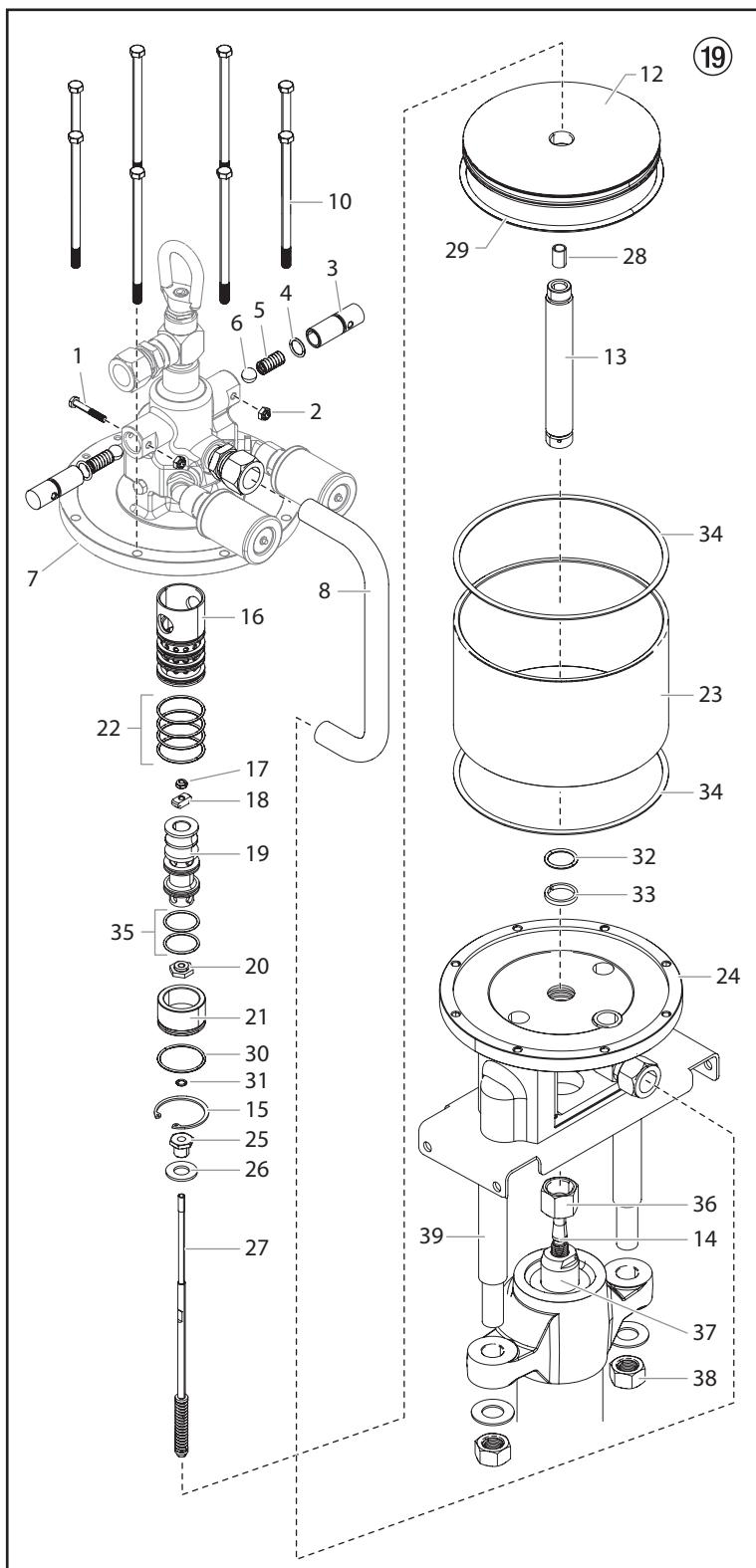
3. Desserrez le raccord du haut (5) qui fixe le bout du tuyau d'air. NE PAS desserrer le raccord du bas.
