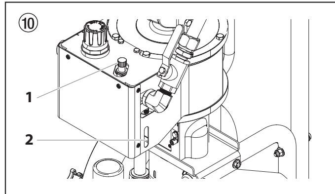
Vérifiez le taux d'injection en observant le débit par les ouvertures sur le côté du capot du moteur pneumatique.
