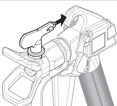
3. Appuyez une fois sur la détente du pistolet pour que la pression débouche la buse. N'appuyez JAMAIS deux fois de suite sur la détente lorsque la buse est dans la position inversée. Cette procédure peut être répétée jusqu'à ce que la buse ne soit plus obstruée.
