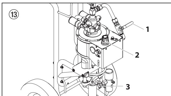
9. Ouvrez la soupape d'arrêt (fig. 13, pos. 1). La poignée devrait maintenant être en ligne avec la vanne.
