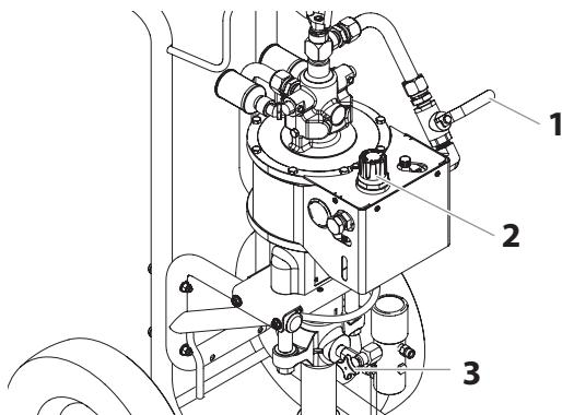
7. Ouvrez la soupape d'arrêt (1). La poignée devrait maintenant être en ligne avec la vanne.
