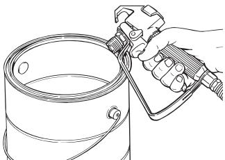
15. Déclenchez le pistolet dans le conteneur de déchets en métal jusqu'à ce que le solvant usagé soit vidangé et que du solvant frais sorte du pistolet.
